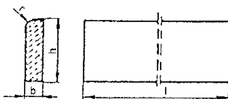
Rysunek 1. Kształt betonowego obrzeża chodnikowego
